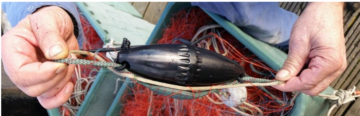
Abbildung 5: PAL-Befestigung an einer Stellnetzoberleine (Foto: Boris Culik)
