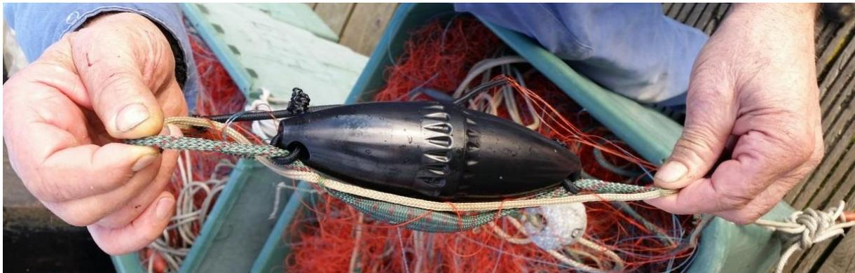
**Abbildung 5: PAL-Befestigung an einer Stellnetzoberleine (Foto: Boris Culik)**
