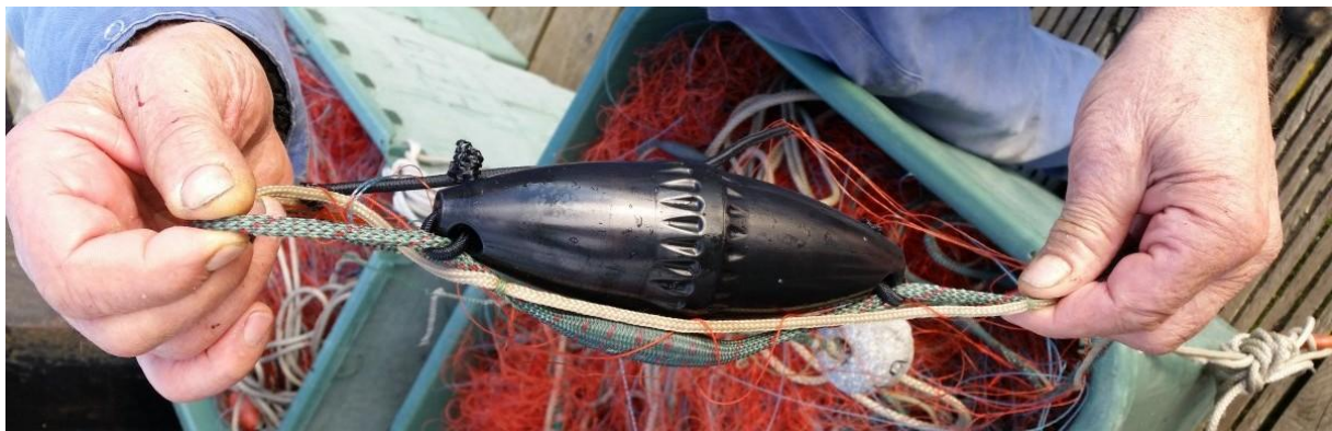
Abbildung 5: PAL-Befestigung an einer Stellnetzoberleine (Foto: Boris Culik)
